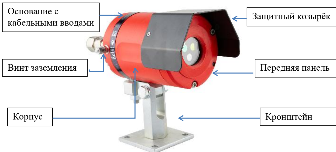
Рисунок 3 – Извещатель многодиапазонный инфракрасный ИП 330-2-1 МСП
