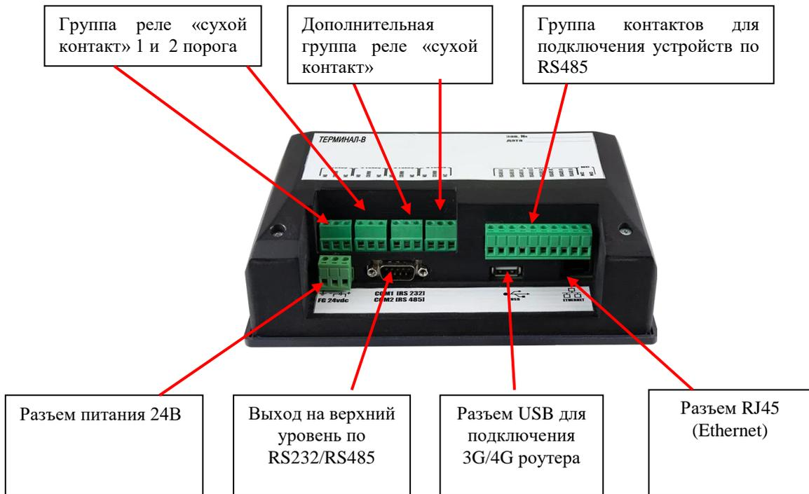
Рис.2А Обратная сторона терминала
