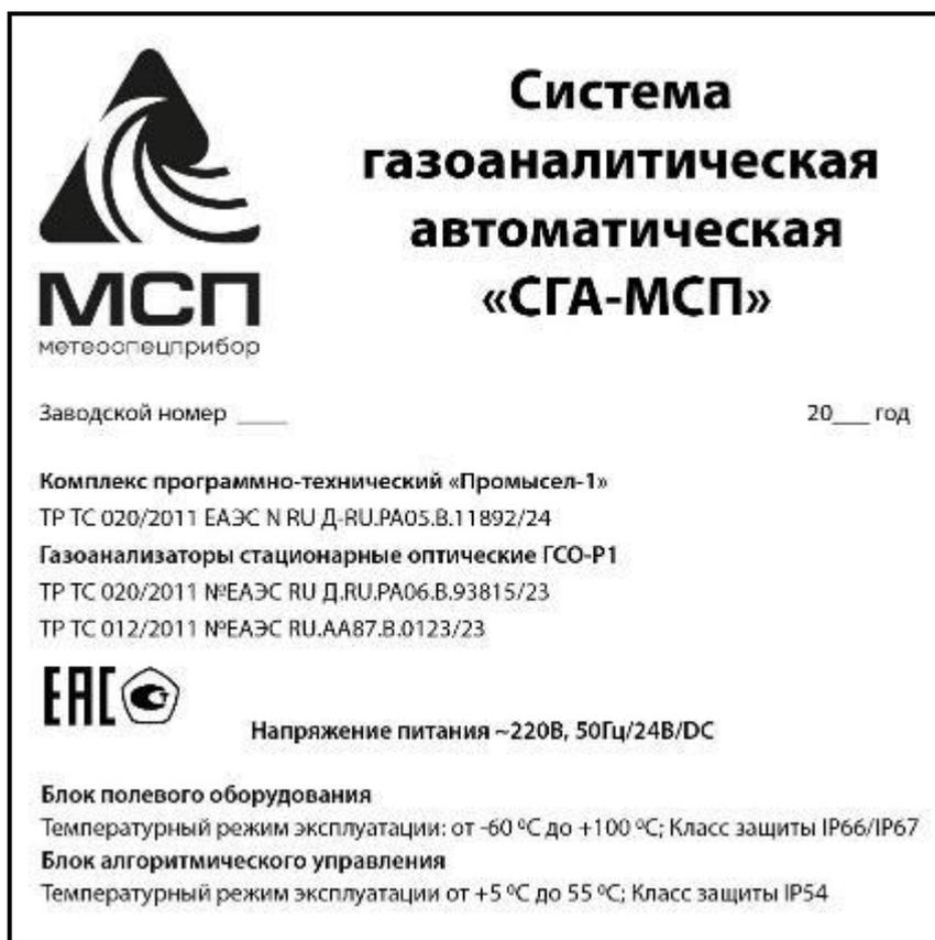
Рисунок 1 – Вид маркировочной таблички
