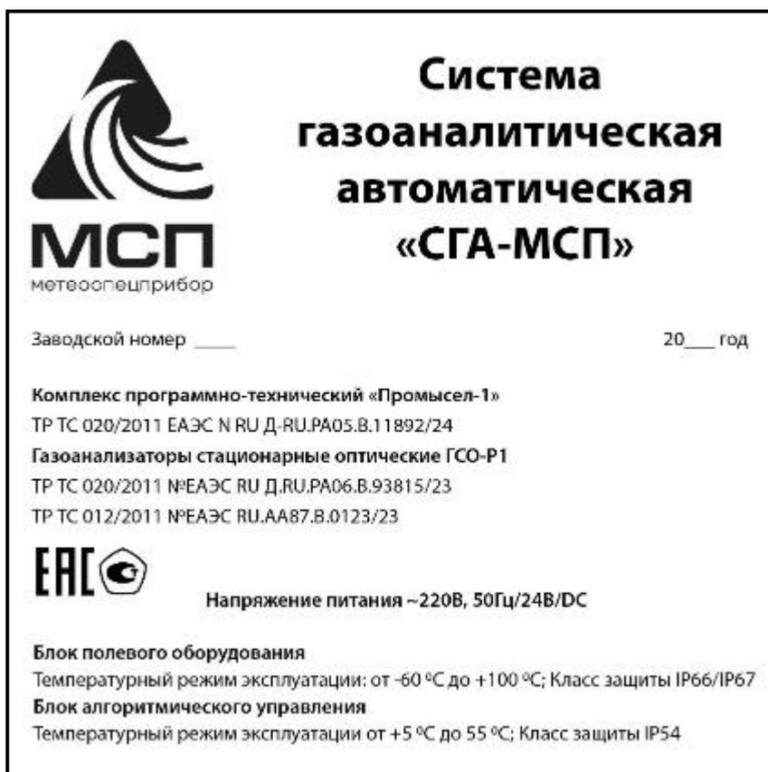
Рисунок 1 – Вид маркировочной таблички
