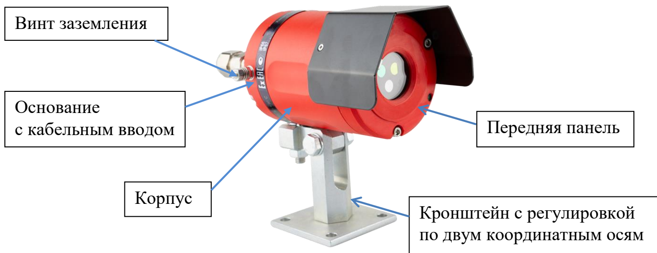
Рисунок 3. Извещатель многодиапазонный ИП 330-2-1 МСП, реагирующий на инфракрасное (ИК) излучение в трех диапазонах
