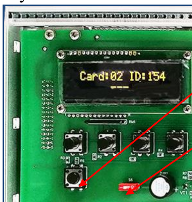
Рисунок 4 – Кнопки под фальш-панелью
