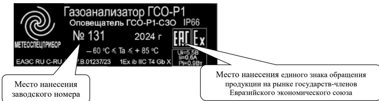
Рисунок 9 – Общий вид таблички, расположенной на корпусе оповещателя ГСО-Р1-С30
