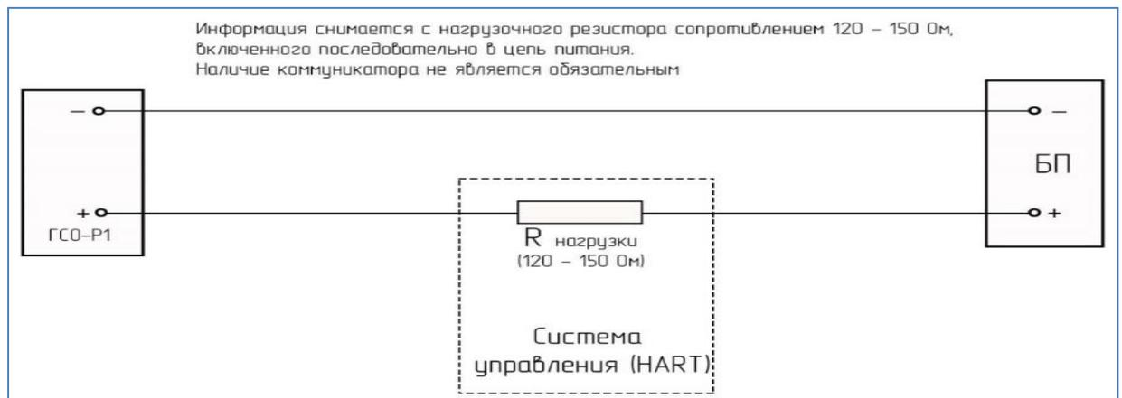
Рисунок А.14 – Подключение газоанализатора ГСО-Р1 в систему сбора информации через HART-интерфейс
